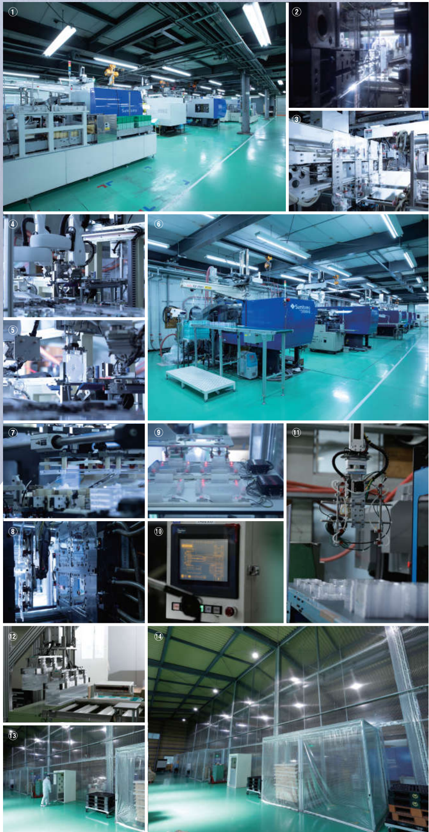
① 350 トン成形機 4 基並列 場内 ② 世界最軽量 CD ケース生産ライン / 金型 ③ 世界最軽量 CD ケース生産ライン / 高速 横取出機 ④ マルチケース組立自動機械 (双腕ロボット仕様) ⑤ マルチケース組立自動機械 中心部アップ ⑥ 180 トン成形機 6 基並列 場内 ⑦ ケース組立機: 社内設計 (ボトムとリッドを嵌合させる) ⑧ トレイ排出検知インターロック機構: 社内設計 ⑨ 製品異常検出装置: 社内設計 ⑩ 制御モニター ⑪ 成形品 チャックプレート: 社内製作 ⑫ 製品自動搬送装置 ⑬ クリーンブース (エアシャワー) ⑭ クリーンブース (全景: 空気清浄機 / 陽圧機 設置)
